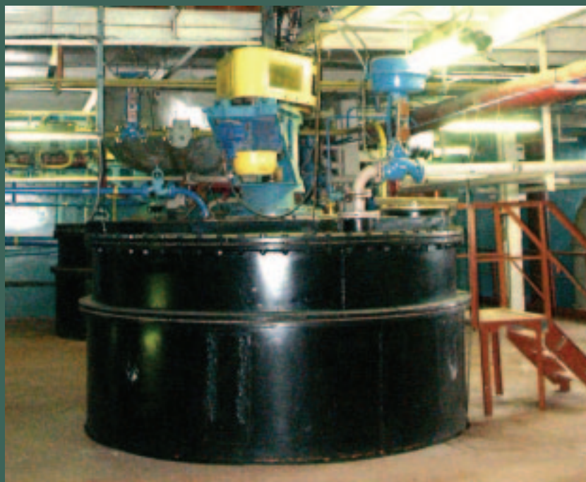
А так выглядит промышленный реактор, в котором на химическом заводе в Перми получают акриламид с помощью микробов по технологии, разработанной в «Биоамиде»
