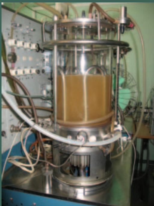
Так выглядит лабораторный ферментер, в котором выращивают микробов – будущие биокатализаторы
